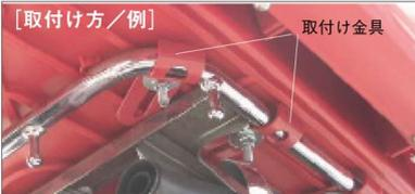
付属の取付け金具を、リアキャリアに引っ掛け、BOX中側から固定します。
